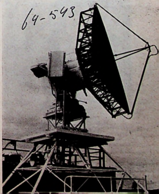
De getransistoriseerde Decca D202 radar uitrusting voor schepen van kleiner tonnage, welke niet met de conventionele apparaten uitgerust kunnen worden.
